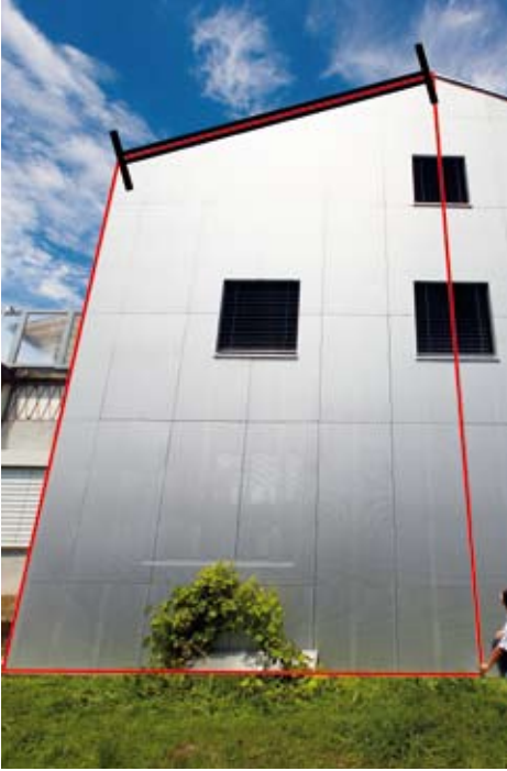
사다리꼴 측정 기능은 지붕 경사를 측정하는 간단한 방법을 제공합니다.
