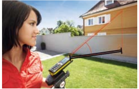
장애물이 있어도 수평 거리를 측정할 수 있습니다. 이것은 경사계가 있어서 가능합니다.
